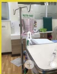
ภาพแสดงการทดสอบที่ระดับความสูง 26 เซนติเมตร ซึ่งเทียบเท่ากับความดัน 20 mmHg
